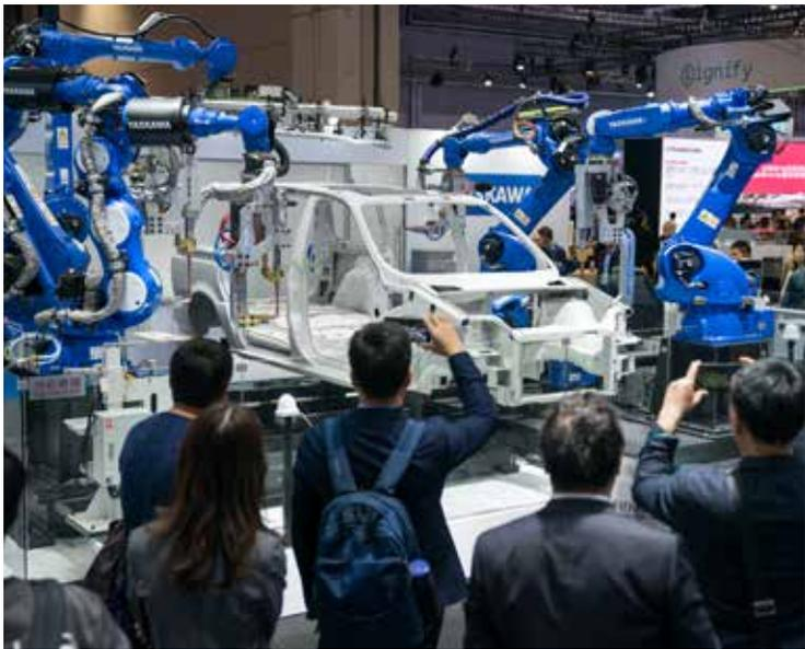
第二届进博会装备展区内，安川电机在展台中央布局了一段由6台机器人组装而成的汽车点焊工位，3分钟内便可完成一辆汽车的车身焊接。（摄影/人民画报社记者徐讯）
